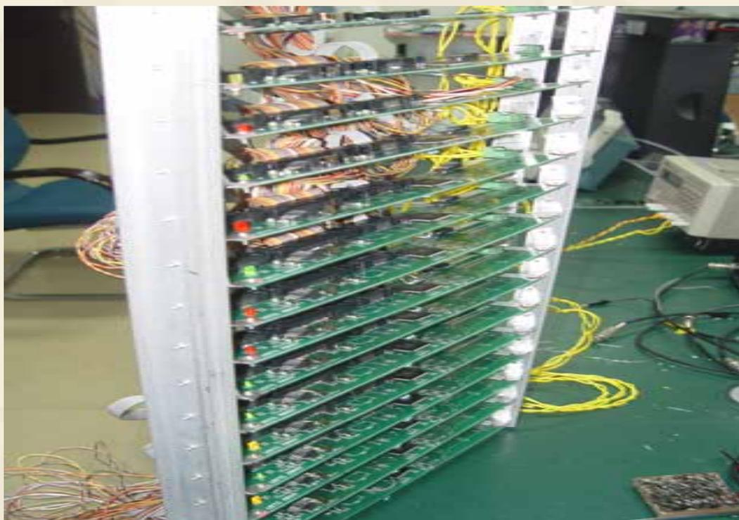
测量 $e^+e^-$ 反应末态中的 $\mu$ 子，通过多层测量给出他们的位置和飞行轨迹
